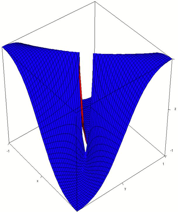
Die "Tangentialebene"  $z = 0$  (grau) im Punkt  $(0,0)$  berechnet mit Hilfe der existierenden partiellen Ableitungen im Punkt  $(0,0)$ , die beide gleich 0 sind, stimmt zwar entlang der  $x$ - und der  $y$ -Achse exakt mit der Funktion  $f$  überein, approximiert die Funktion in der Nähe von  $(0,0)$  aber nicht gut (ist eben keine Tangentialebene!); die partiellen Ableitungsfunktionen sind nämlich nicht stetig, die Funktion  $f$  ist in  $(0,0)$  nicht differenzierbar, ja nicht einmal stetig!
