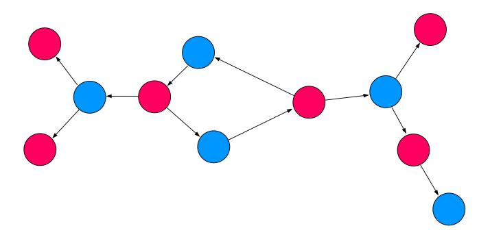
Edge Insertion: Bad case: inserting an edge into a cyclic component
